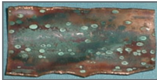
Fig. 3 – Corrosión por aireación diferencial en tubería de cobre
