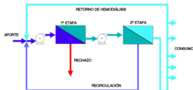
Fig. 47 – Esquema de funcionamiento de una bi-ósmosis inversa
