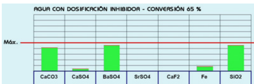
Fig. 41 – Ejemplo de precipitación de sales ajustando la conversión
