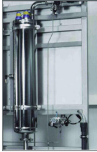
Fig. 48 – Equipo de desinfección por radiación UV para hemodiálisis
