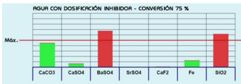
Fig. 40 – Ejemplo de precipitación de sales dosificando un inhibidor
